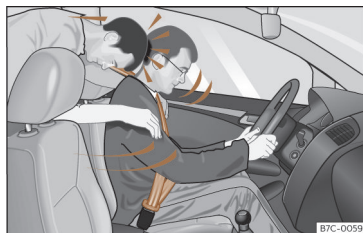
Fig. 36 L'occupant de la banquette arrière non attaché est projeté en avant et vient heurter le conducteur attaché.
