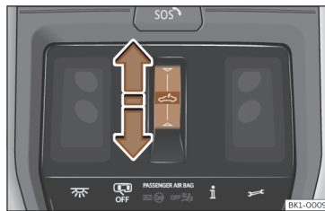
Fig. 112 Sur le revêtement intérieur du toit : bouton de fonction du store pare-soleil.
