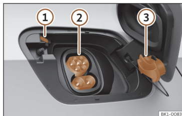
Fig. 69 Derrière la trappe de la prise de charge de la batterie, à l'arrière droit : prise de charge.
