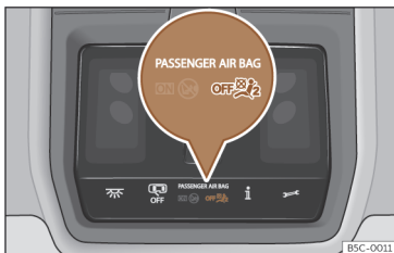
Fig. 44 Dans la console du toit : témoin de contrôle de la désactivation de l'airbag du passager avant.
