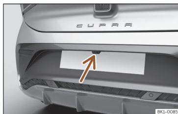
Fig. 123 Sur le pare-chocs arrière : emplacement de la caméra de l'assistant de marche arrière.
