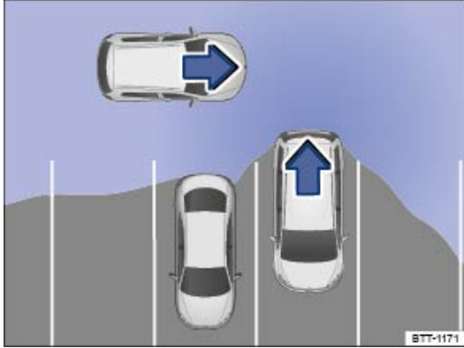
Fig. 133 Schéma de principe de l'assistant de sortie de stationnement : zone surveillée autour du véhicule sortant de la place de stationnement
