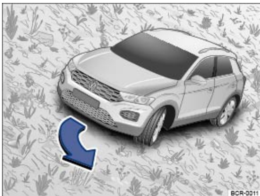
Fig. 115 Braquage en direction de la ligne de plus grande pente
