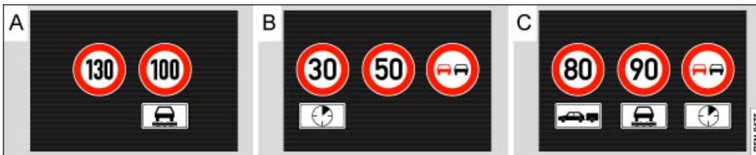
Fig. 14 Sur l'afficheur du combiné d'instruments : exemples de panneaux de limitation de vitesse et d'interdiction de dépassement détectés avec les panneaux supplémentaires correspondants
