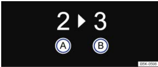
Fig. 96 Afficheur du combiné d'instruments : recommandation de rapport
