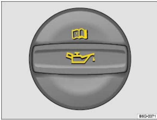
Fig. 187 Dans le compartiment-moteur : bouchon de l'orifice de remplissage d'huile-moteur (schéma de principe)
