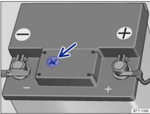
Fig. 192 Regard de batterie situé sur la face supérieure de la batterie 12 V (schéma de principe)
