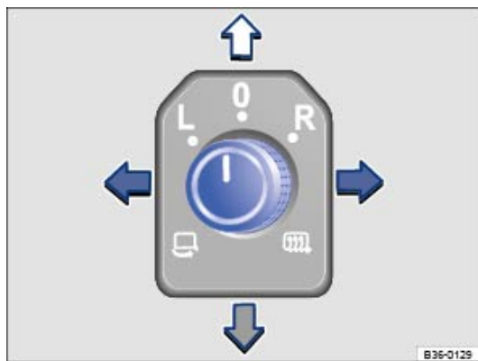
Fig. 88 Dans la porte du conducteur : bouton rotatif pour les rétroviseurs extérieurs
