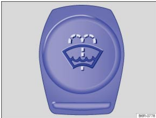
Fig. 185 Dans le compartiment-moteur : bouchon du réservoir de lave-glace
