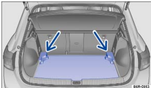
Fig. 149 Dans le coffre à bagages : ouverture du plancher
