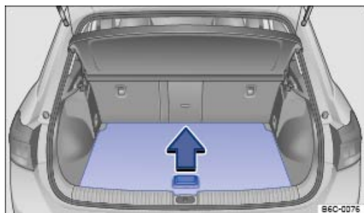
Fig. 147 Dans le coffre à bagages : ouverture du plancher
