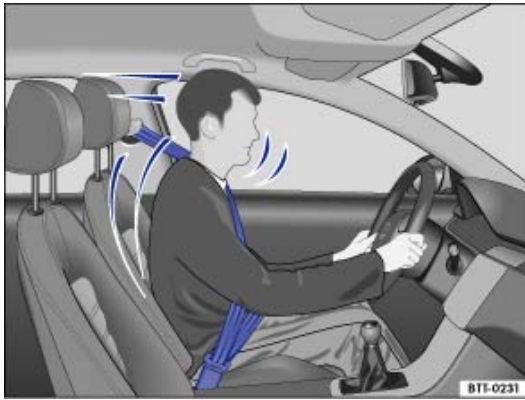
Fig. 33 Conducteur correctement attaché, retenu par sa ceinture de sécurité lors d'un freinage brusque
