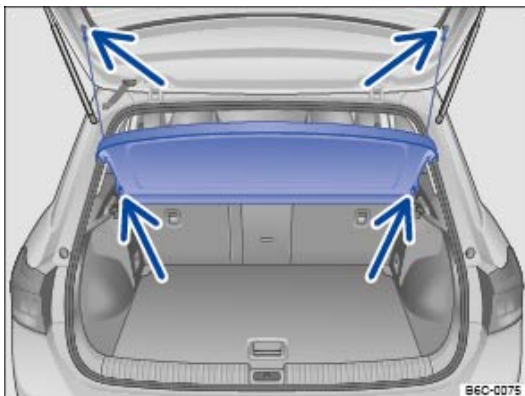
Fig. 146 Dans le coffre à bagages : dépose et repose du couvre-coffre
