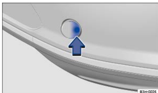
Fig. 178 À droite sur le pare-chocs arrière : retrait du cache
