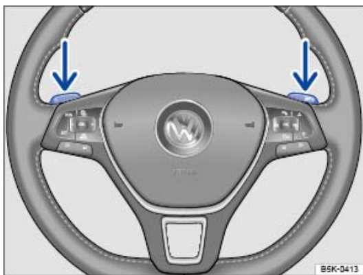
Fig. 107 Volant avec palettes pour passage des rapports de la commande Tiptronic
