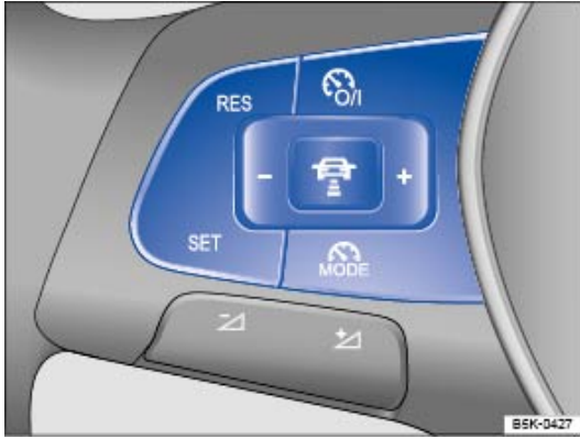
Fig. 117 Côté gauche du volant multifonction : touches de commande du limiteur de vitesse
