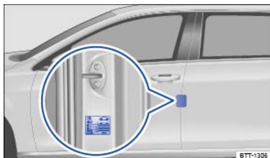
Fig. 195 Sur le montant de la porte du conducteur : plaquette de pression de gonflage des pneus (ou sur la face intérieure de la trappe à carburant)
