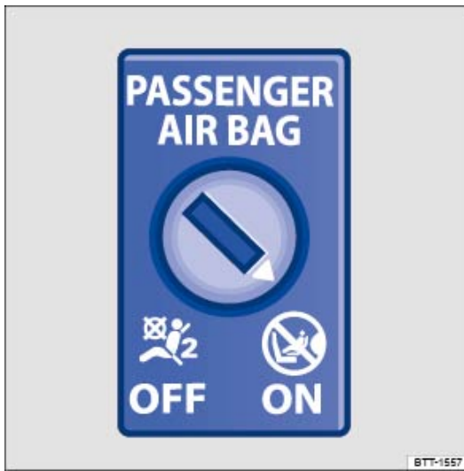
Fig. 42 Dans le tableau de bord côté passager avant : commande à clé de désactivation et d'activation du sac gonflable du passager avant
