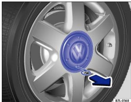
Fig. 199 Retrait de l'enjoliveur central par extraction
