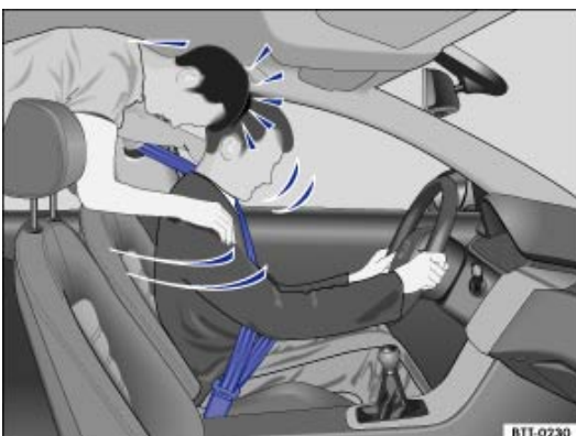
Fig. 32 Le passager arrière non attaché est projeté en avant et vient heurter le conducteur attaché
