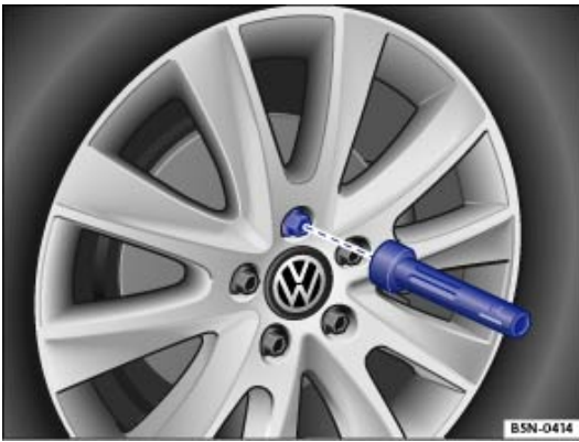
Fig. 207 Changement d'une roue : dévissage des boulons de roue à l'aide du manche de tournevis
