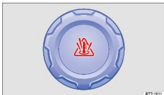
Fig. 189 Dans le compartiment-moteur : bouchon du vase d'expansion du liquide de refroidissement du moteur (schéma de principe)
