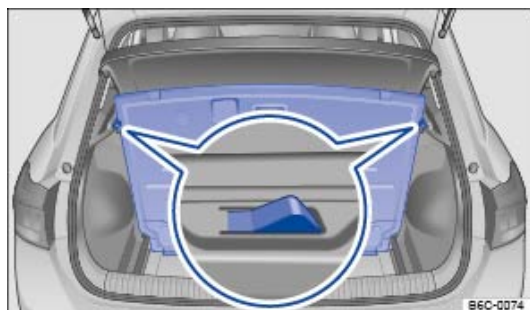
Fig. 148 Dans le coffre à bagages : accrochage du plancher de coffre à bagages
