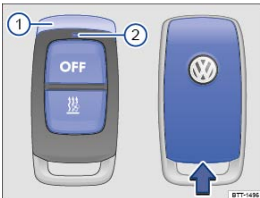
Fig. 93 Chauffage stationnaire : radiocommande (à gauche) avec compartiment à pile (à droite).
