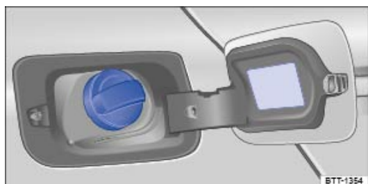
Fig. 158 Derrière la trappe à carburant : bouchon de réservoir
