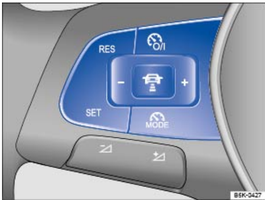
Fig. 121 Côté gauche du volant multifonction : touches de commande du régulateur de distance
