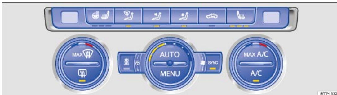
Fig. 92 Dans la partie supérieure de la console centrale : barre climatiseur du climatiseur à régulation automatique (Climatronic)
