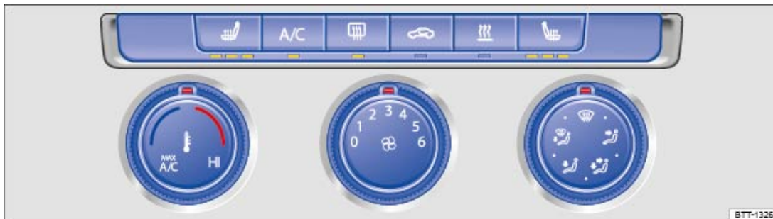
Fig. 91 Dans la partie supérieure de la console centrale : barre du climatiseur à régulation manuelle ou du système de chauffage et de ventilation
