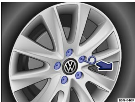
Fig. 202 Retrait des capuchons des boulons de roue
