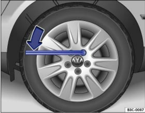
Fig. 203 Changement d'une roue : desserrage des boulons de roue
