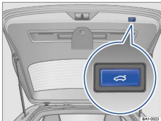
Fig. 63 Dans le capot arrière ouvert : touche de fermeture électrique du capot arrière
