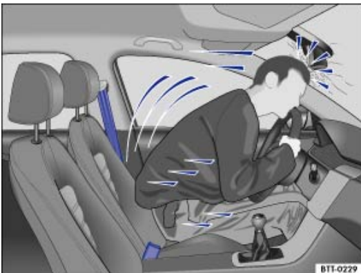
Fig. 31 Le conducteur non attaché est projeté en avant
