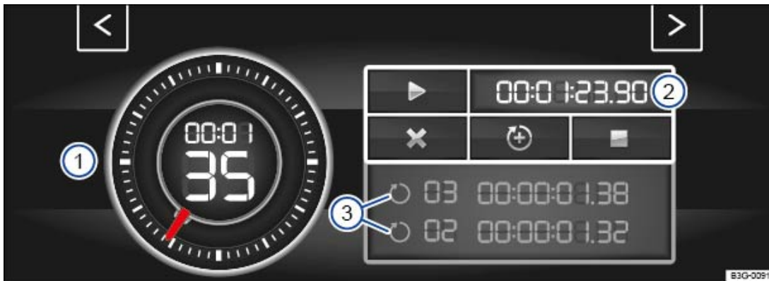
Fig. 24 Sur l'afficheur du système d'infodivertissement : compteur de tours avec chronographe, bouton de fonction et temps de tour
