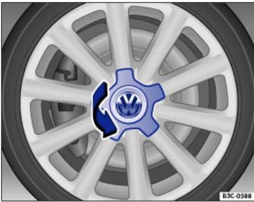
Fig. 200 Retrait de l'enjoliveur central par rotation
