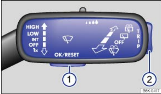
Fig. 20 À droite sur la colonne de direction : touches sur le levier d'essuie-glace (schéma de principe).
