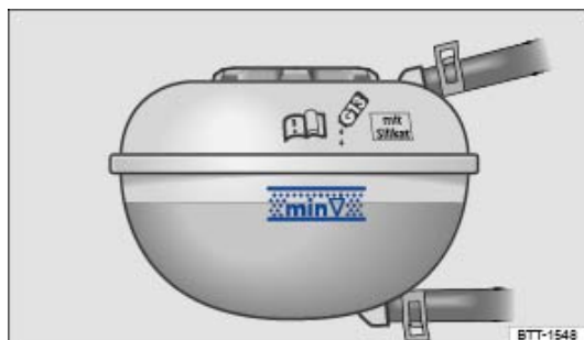
Fig. 188 Dans le compartiment-moteur : repères sur le vase d'expansion du liquide de refroidissement (schéma de principe)
