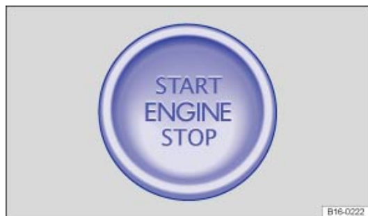
Fig. 100 Dans la partie inférieure de la console centrale : bouton de démarrage du moteur
