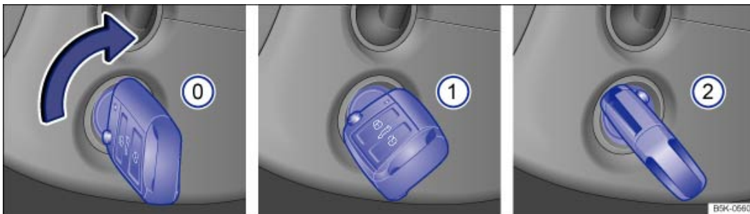
Fig. 99 À droite du volant de position : positions de la clé du véhicule dans le contact-démarrreur
