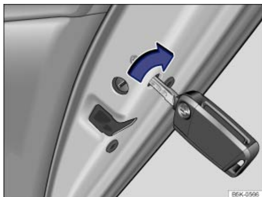
Fig. 58 Sur le chant de la porte arrière droite : verrouillage d'urgence du véhicule à l'aide de la clé du véhicule
