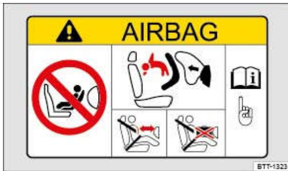
Fig. 87 Schéma de principe : Marquage du sac gonflable sur le pare-soleil
