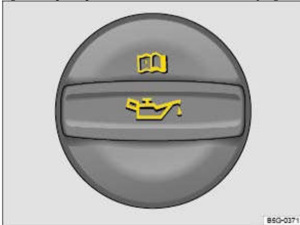
Fig. 229 Dans le compartiment-moteur : bouchon de l'orifice de remplissage d'huile-moteur (schéma de principe)
