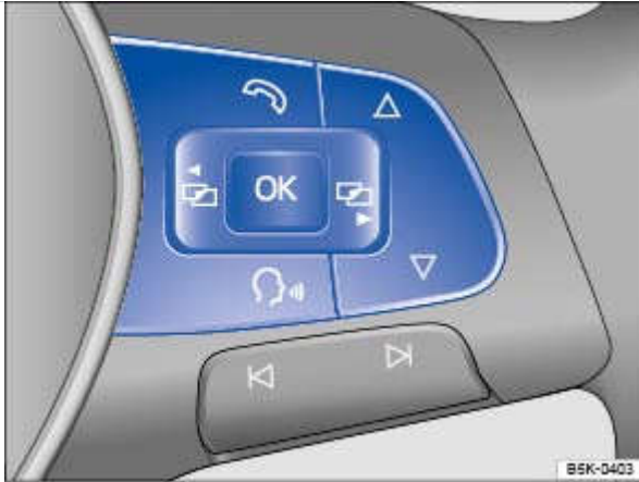
Fig. 23 Côté droit du volant multifonction : touches de commande des menus et des informations sur le combiné d'instruments
