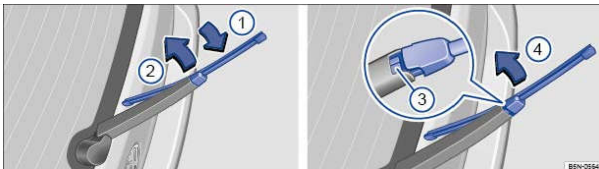
Fig. 243 Remplacement du balai d'essuie-glace arrière
