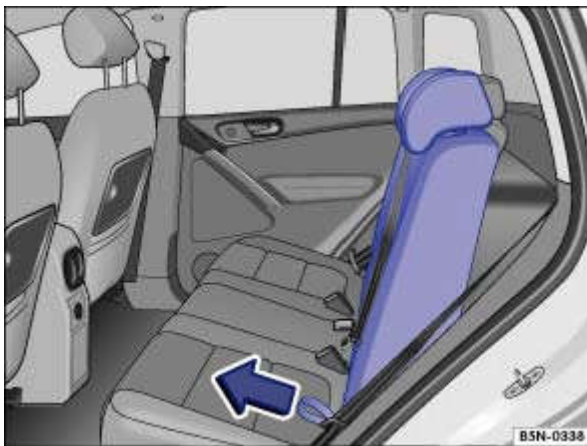
Fig. 63 Escamotage et relèvement du dossier de banquette arrière
