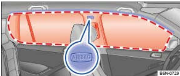
Fig. 83 Côté gauche du véhicule : emplacement de montage et zone de déploiement du sac gonflable de tête
