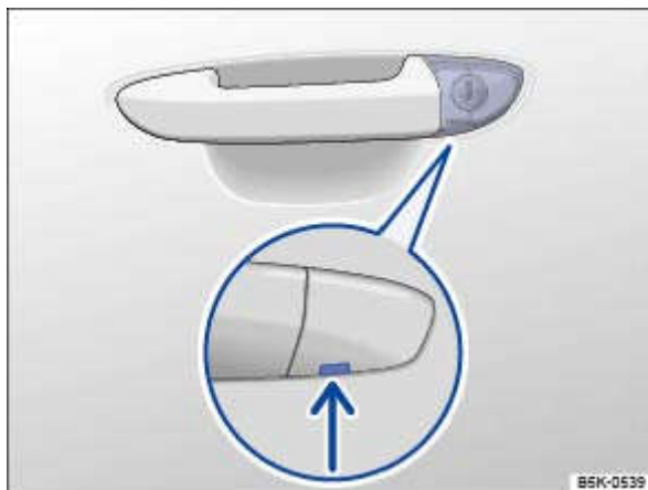
Fig. 250 Poignée de la porte du conducteur : barillet masqué
