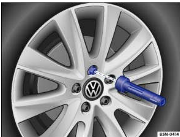
Fig. 266 Changement de roue : dévissage des boulons de roue à l'aide du manche de tournevis
