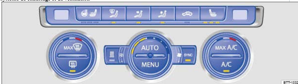
Fig. 209 Dans la partie supérieure de la console centrale : éléments de commande du climatiseur à régulation automatique (Climatronic)
