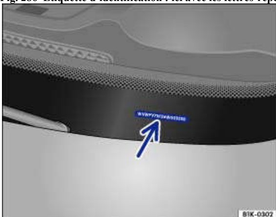
Fig. 287 Sur le pare-brise : numéro d'identification du véhicule
