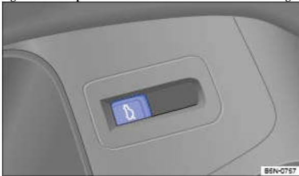
Fig. 29 Dans la porte du conducteur : déverrouillage du capot arrière
