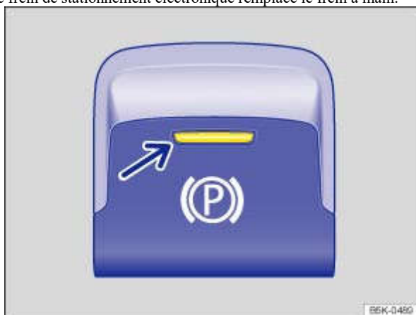
Fig. 152 Dans la partie inférieure de la console centrale : touche du frein de stationnement électronique
