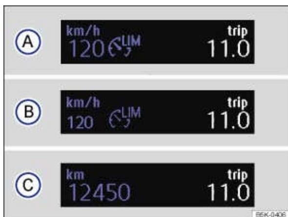
Fig. 184 Sur l'afficheur du combiné d'instruments : indications sur l'état du limiteur de vitesse
