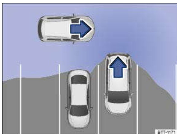
Fig. 202 Zone surveillée autour du véhicule sortant de la place de stationnement
