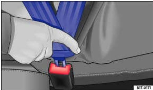
Fig. 72 Insertion du pêne de la ceinture de sécurité dans le boîtier de verrouillage
