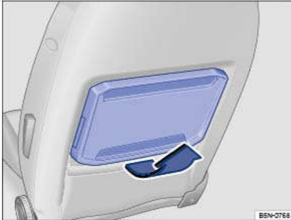
Fig. 132 Sur le siège avant : ouverture de la tablette escamotable
