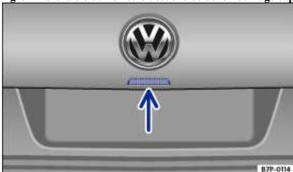
Fig. 38 Déverrouillage et ouverture du capot arrière de l'extérieur
