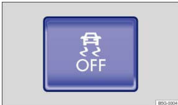
Fig. 153 Dans la partie inférieure de la console centrale : touche d'activation/de désactivation manuelle de l'antipatinage, de l'antipatinage avec programme électronique de stabilisation ou de l'ESC Sport
