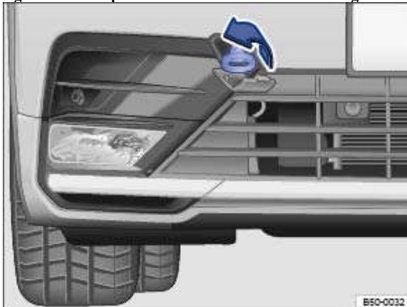
Fig. 284 Dans le pare-chocs avant, côté droit : vissage de l'œillet de remorquage
