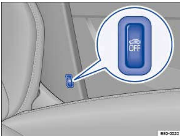
Fig. 31 À côté du siège du conducteur : touche de désactivation de la protection volumétrique et de la protection anti-soulèvement
