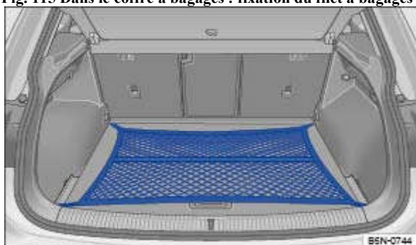
Fig. 116 Dans le coffre à bagages : fixation du filet à bagages au plancher du coffre à bagages (en fonction de l'équipement)
