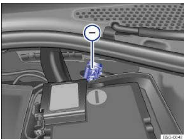
Fig. 279 Dans le compartiment-moteur : prise de démarrage de fortune (raccord à la masse)
