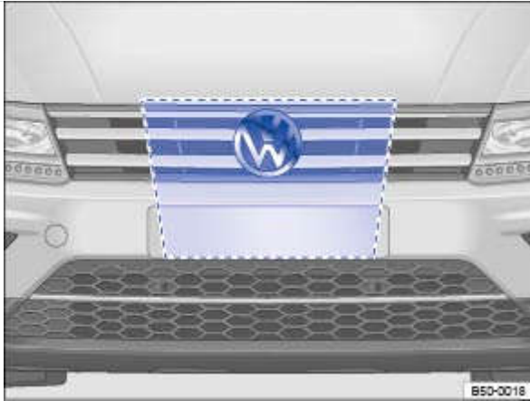
Fig. 194 Dans la grille de calandre derrière l’emblème Volkswagen : capteur à radar et zone devant rester dégagée autour du capteur à radar
