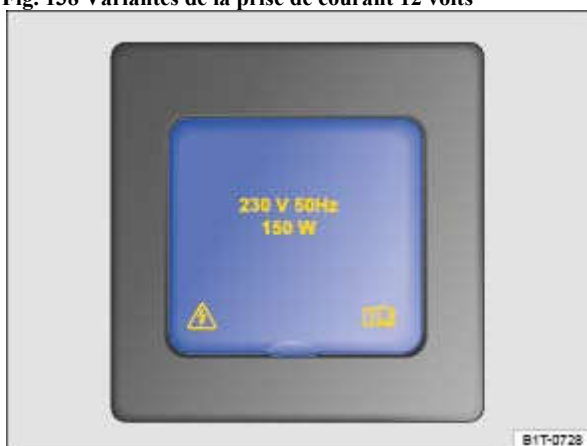
Fig. 139 Dans le côté gauche du coffre à bagages : prise de courant 230 volts
