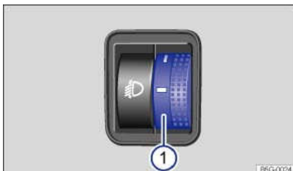
Fig. 95 À côté du volant : molette de réglage du site des projecteurs ①
