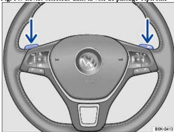
Fig. 150 Volant de direction avec palettes pour passage des rapports de la commande Tiptronic
