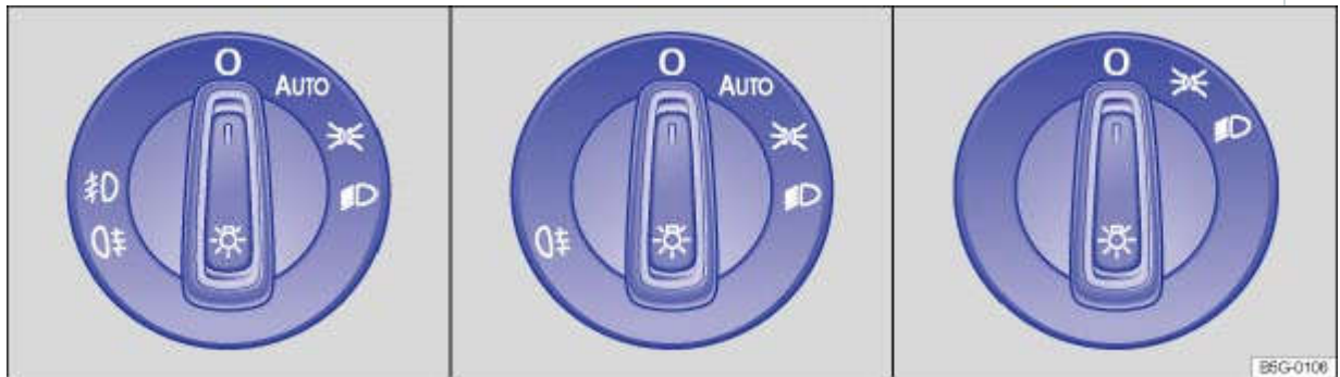
Fig. 94 À côté du volant : représentation de certaines versions de la commande d'éclairage
