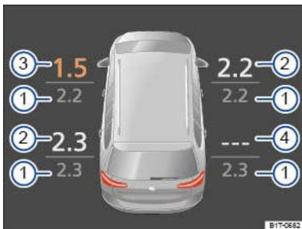
Fig. 235 Schéma de principe de l'affichage sur le combiné d'instruments : pressions de gonflage actuelles des pneus
