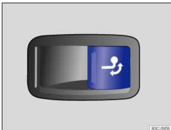
Fig. 121 À gauche dans le coffre à bagages : touche de déverrouillage de la boule d'attelage
