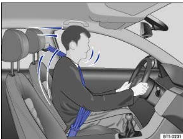
Fig. 71 Conducteur correctement attaché, retenu par sa ceinture de sécurité lors d'un freinage brusque
