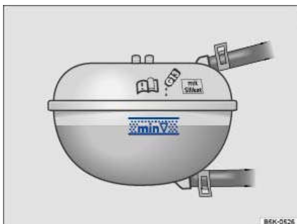
Fig. 231 Dans le compartiment-moteur : repères sur le vase d'expansion du liquide de refroidissement
