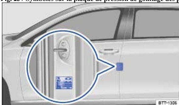
Fig. 238 Sur le montant de la porte du conducteur : plaquette de pression de gonflage des pneus (ou sur la face intérieure de la trappe à carburant)
