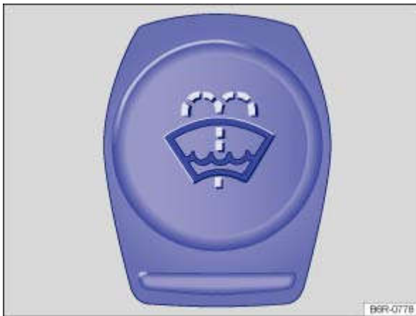
Fig. 103 Dans le compartiment-moteur : bouchon du réservoir de liquide de lave-glace
