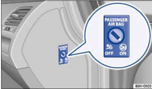
Fig. 80 Dans la boîte à gants : commande à clé de désactivation et d'activation du sac gonflable frontal du passager avant
