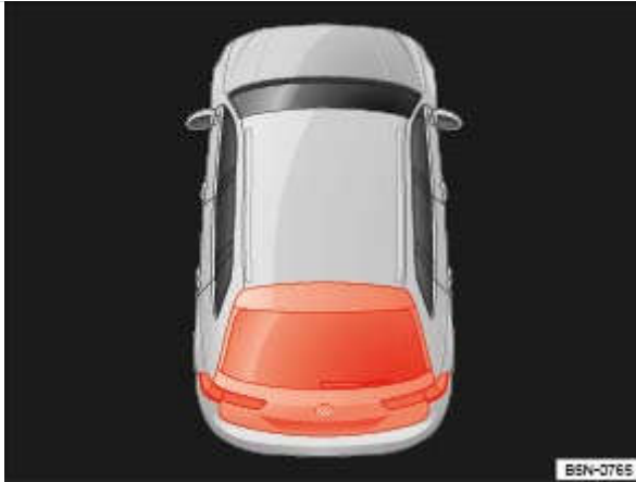
Fig. 36 Sur l'afficheur du combiné d'instruments : capot arrière ouvert ou mal fermé
