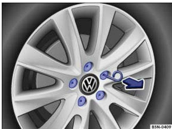
Fig. 261 Retrait des capuchons de boulons de roue
