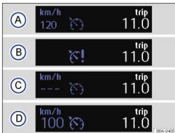
Fig. 181 Sur l'écran du combiné d'instruments : indications d'état du régulateur de vitesse
