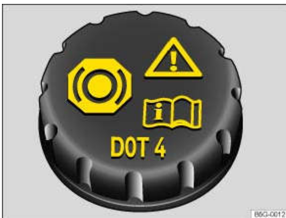
Fig. 154 Dans le compartiment-moteur : bouchon du réservoir de liquide de frein
