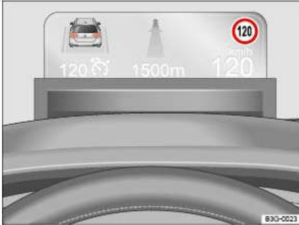
Fig. 21 Au niveau du tableau de bord au-dessus du volant de direction : affichage tête haute
