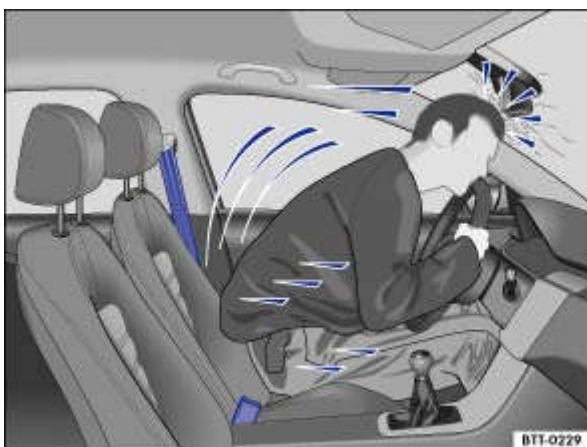
Fig. 69 Le conducteur non attaché est projeté en avant
