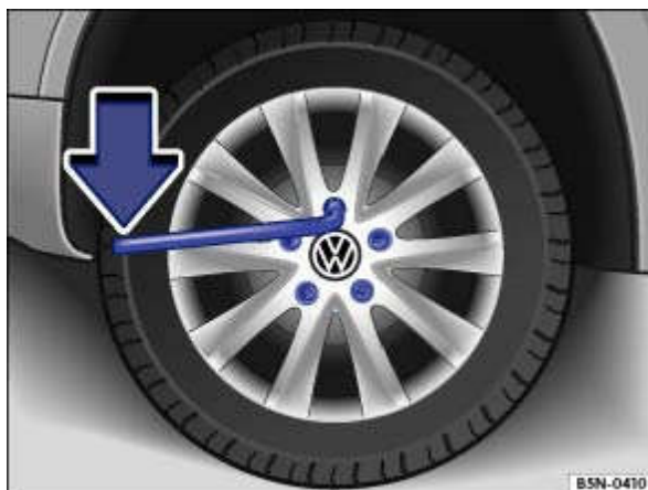
Fig. 262 Changement de roue : desserrage des boulons de roue
