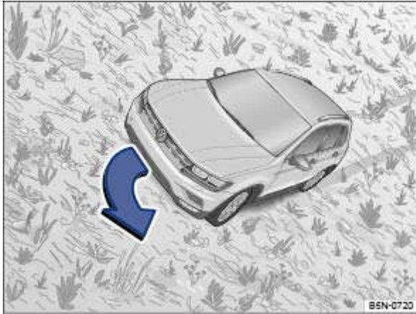
Fig. 223 Braquage en direction de la ligne de plus grande pente
