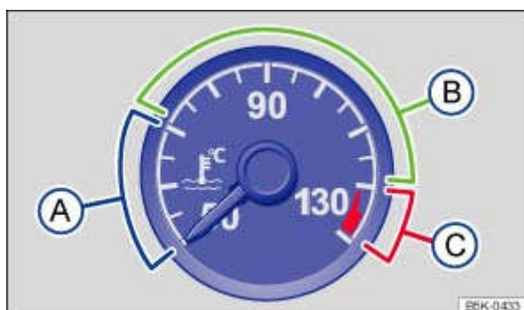
Fig. 230 Détail du combiné d'instruments : indicateur de température du liquide de refroidissement (schéma de principe)
