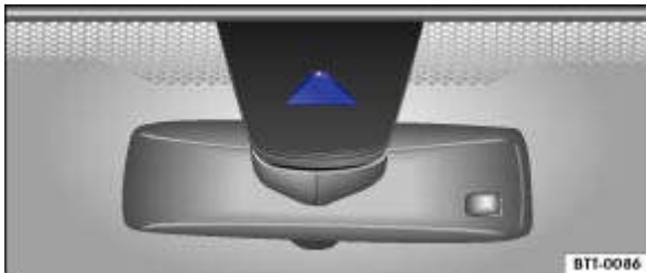
Fig. 198 Sur le pare-brise : regard de la caméra de l'assistant de maintien de voie
