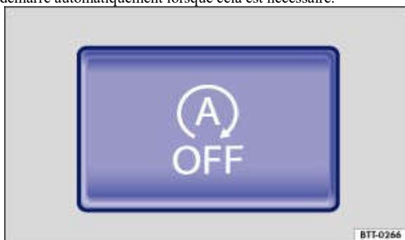
Fig. 158 Dans la partie inférieure de la console centrale : touche du dispositif start/stop de mise en veille
