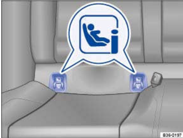
Fig. 90 Sur le siège : identification des points d'ancrage ISOFIX des sièges pour enfants
