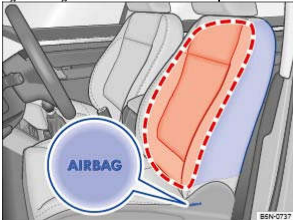
Fig. 82 Sur le côté du siège avant : emplacement de montage et zone de déploiement du sac gonflable latéral
