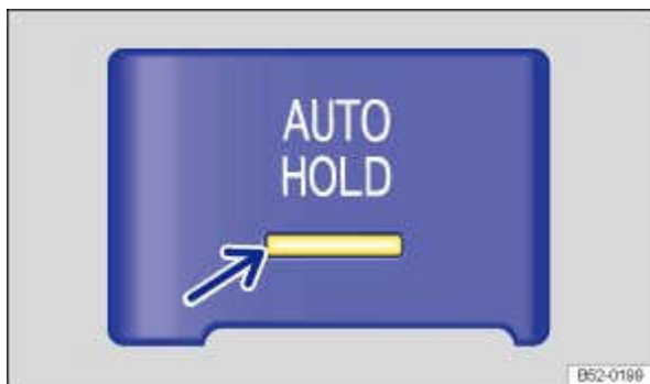
Fig. 157 Dans la partie inférieure de la console centrale : touche de la fonction Auto Hold
