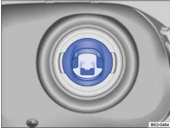
Fig. 216 Trappe à carburant ouverte : détrompeur de ravitaillement dans la goulotte de remplissage de carburant
