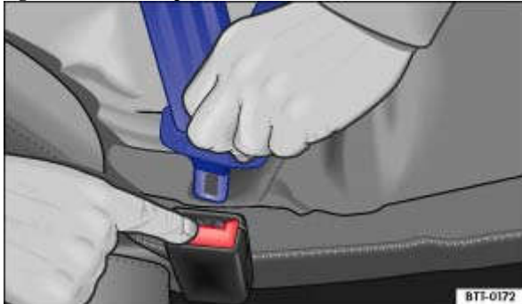
Fig. 73 Libération du pêne du boîtier de verrouillage
