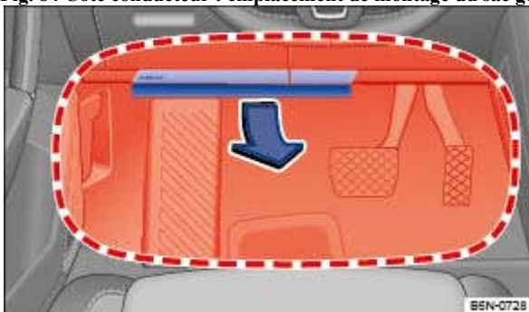
Fig. 85 Côté conducteur : zone de déploiement du sac gonflable de genoux
