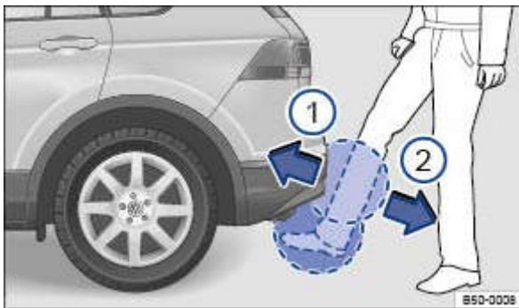
Fig. 40 Capot arrière à ouverture pilotée par capteurs (Easy Open)
