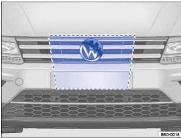
Fig. 188 Dans la grille de calandre derrière l'emblème Volkswagen : capteur à radar et zone devant rester dégagée autour du capteur à radar
