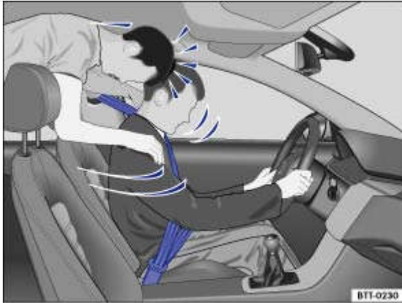
Fig. 70 Le passager arrière non attaché est projeté en avant et vient heurter le conducteur attaché
