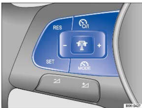
Fig. 189 Côté gauche du volant multifonction : touches de commande du régulateur de distance
