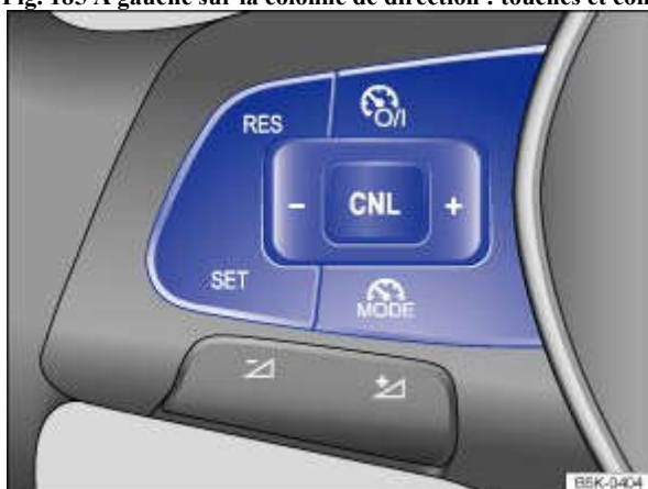
Fig. 186 Côté gauche du volant multifonction : touches de commande du limiteur de vitesse
