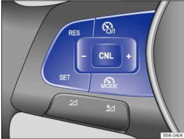
Fig. 183 Côté gauche du volant multifonction : touches de commande du régulateur de vitesse
