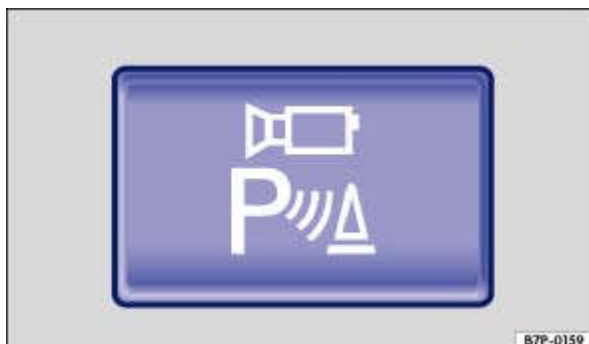
Fig. 179 Dans la partie supérieure de la console centrale : touche d'activation manuelle de la vision périphérique
