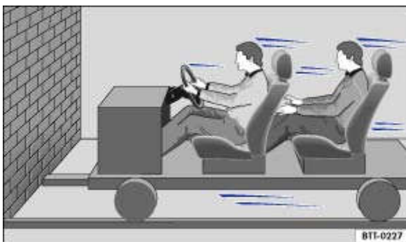
Fig. 67 Véhicule avec occupants non attachés se dirigeant droit sur un mur
