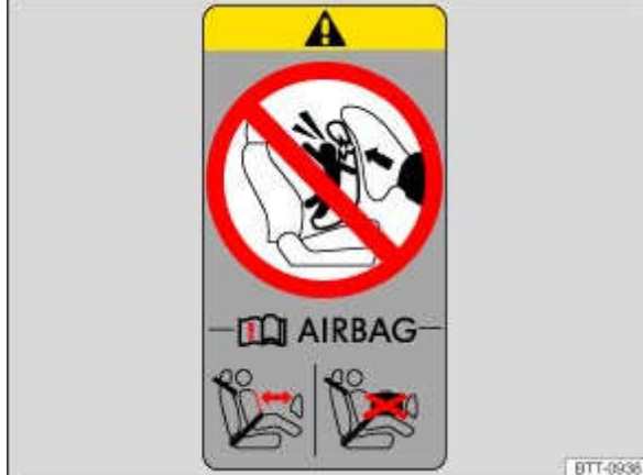
Fig. 88 Schéma de principe : Marquage du sac gonflable sur le montant B
