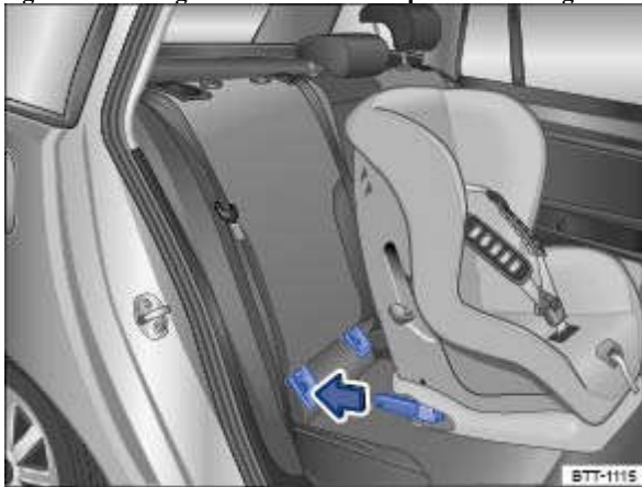
Fig. 91 Schéma de principe : installation d'un siège pour enfants ISOFIX avec verrous
