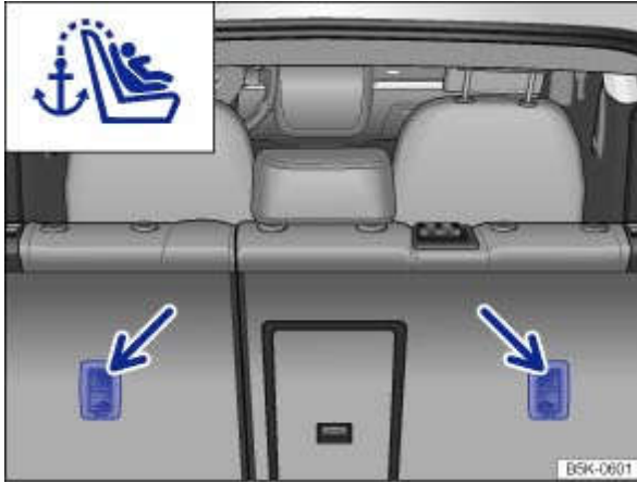
Fig. 92 Œillets de retenue pour ceinture de retenue supérieure au dos de la banquette arrière
