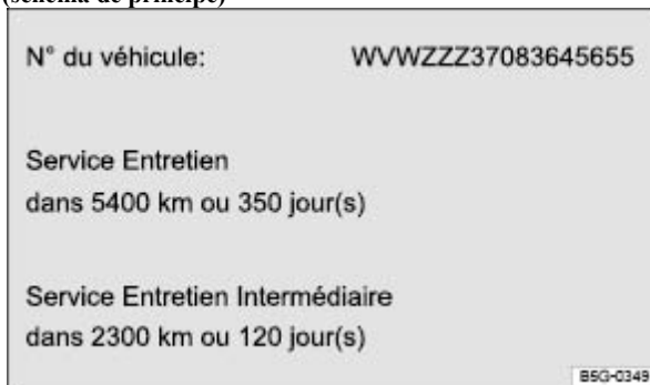
Fig. 19 Écran du système d’infodivertissement : exemple d’affichage d’informations d’entretien (schéma de principe)
