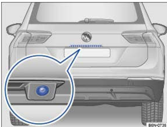
Fig. 165 À l'arrière du véhicule : emplacement de montage de la caméra de recul
