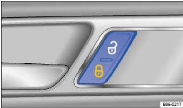
Fig. 28 Dans la porte du conducteur : touche de verrouillage centralisé
