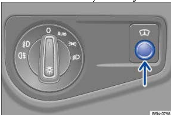
Fig. 20 À côté du volant de direction : régulateur de l'affichage tête haute (flèche)
