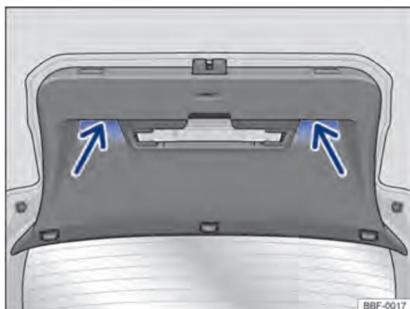
Figure. 60 Capot arrière ouvert : évidements (flèches) pour tirer et fermer.
