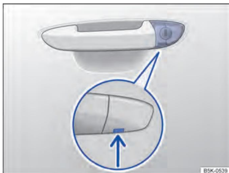
Figure. 54 Poignée de porte conducteur : barillet de serrure recouvert.
