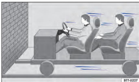
Figure. 23 Un véhicule dont les occupants ne portent pas de ceinture de sécurité est sur une trajectoire de collision avec un mur.
