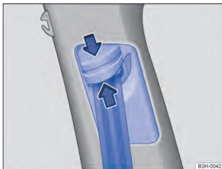
Figure. 32 A côté des sièges avant : réglage en hauteur des ceintures de sécurité.
