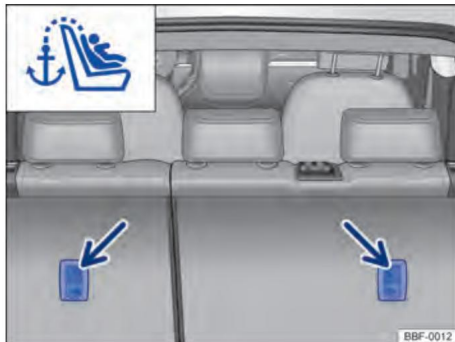
Figure. 43 Cœllets de maintien de la ceinture de fixation supérieure au dossier de la banquette arrière.
