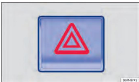
Figure. 46 Dans la partie supérieure de la console centrale : interrupteur des voyants.
