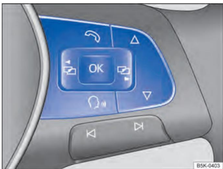
Figure. 19 Côté droit du volant multifonction : touches de commande des menus et d'affichage des informations sur le combiné d'instruments.
