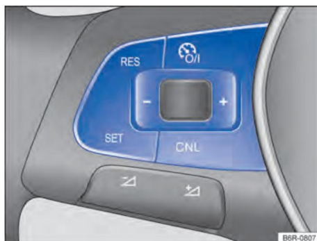
Figure. 100 Côté gauche du volant multifonction : touches de commande du GRA.
