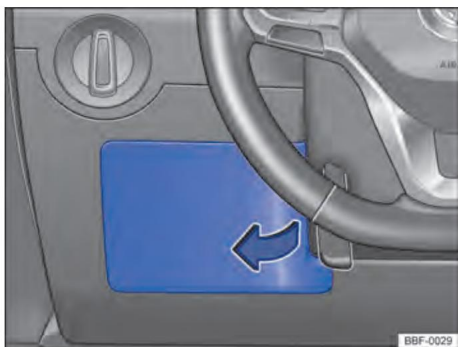
Figure. 143 Côté conducteur du tableau de bord : couvercle de la boîte à fusibles.
