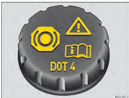
Figure. 162 Dans le compartiment moteur : bouchon du réservoir de liquide de frein.
