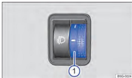
Fig. 76 A côté du volant : correcteur de portée des phares 1.
