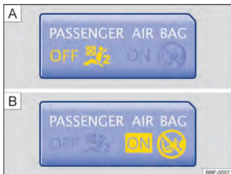
Figure. 33 Dans la partie supérieure de la console centrale : témoin de désactivation de l'airbag frontal du passager avant ou témoin d'activation de l'airbag frontal du passager avant .
