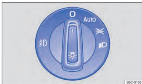
Figure. 74 A côté du volant : interrupteur d'éclairage (une variante).
