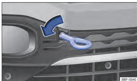
Figure. 153 Sur le pare-chocs avant droit : visser l'anneau de remorquage.
