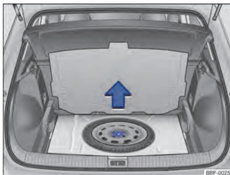
Figure. 133 Dans le coffre, sous le revêtement de sol : roue de secours et outillage de bord.
