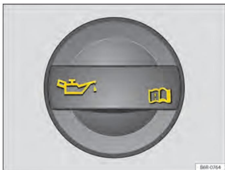
Figure. 159 Dans le compartiment moteur : couvercle de remplissage d'huile moteur.
