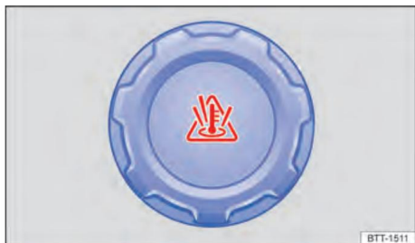
Figure. 161 Dans le compartiment moteur : bouchon du vase d'expansion d'eau moteur.
