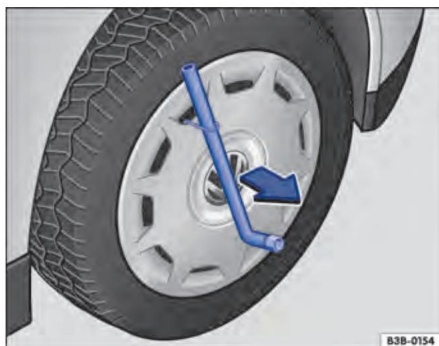
Fig. 171 Retirer la coque intégrale.
