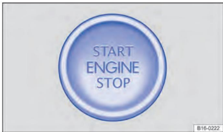
Figure. 92 Dans la partie inférieure de la console centrale : bouton de démarrage pour démarrer le moteur.
