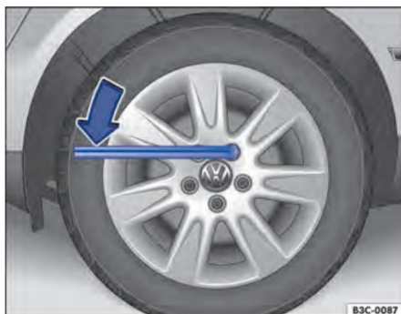
Figure. 172 Changement de roue : desserrez les vis de roue.
