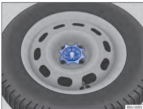
Figure. 169 Dans le coffre : poignée de fixation de la roue de secours.
