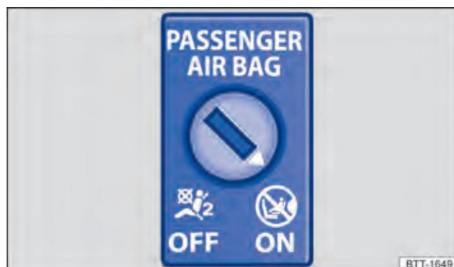
Fig. 36 Au tableau de bord côté passager avant : interrupteur à clé pour l'activation et la désactivation de l'airbag frontal du passager avant.
