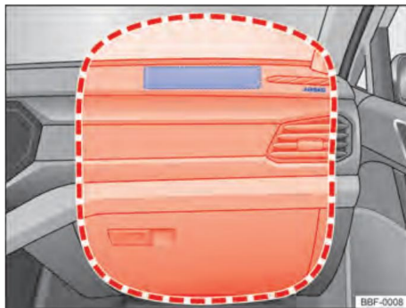
Figure. 35 Emplacement d'installation et zone de déploiement de l'airbag frontal du passager avant.
