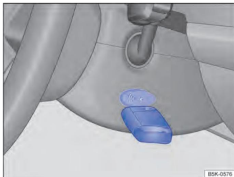
Figure. 93 À droite sur la colonne de direction : fonction de démarrage d'urgence sur les véhicules avec verrouillage Keyless Access et système de démarrage sans clé.
