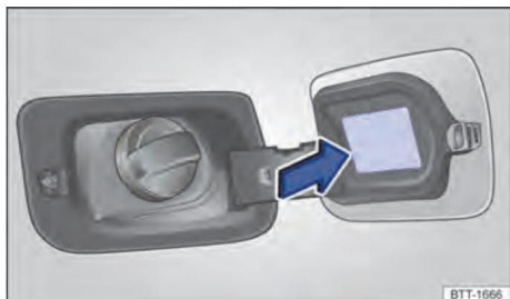
Figure. 167 A l'intérieur de la trappe à carburant : étiquette avec la pression des pneus.
