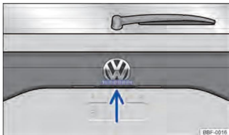
Figure. 59 Sur le hayon : bouton d'ouverture du hayon.
