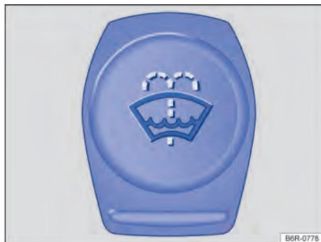
Fig. 157 Dans le compartiment moteur : bouchon du réservoir d'eau de lave-glace.
