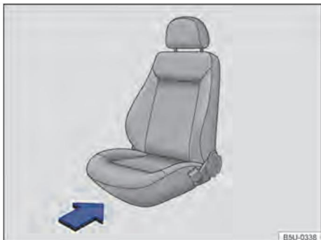
Figure. 48 Sur l'avant du siège passager avant : emplacement pour l'installation du support d'extincteur.
