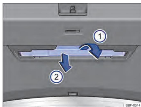
Figure. 47 Au verso : support pour le triangle de sécurité.
