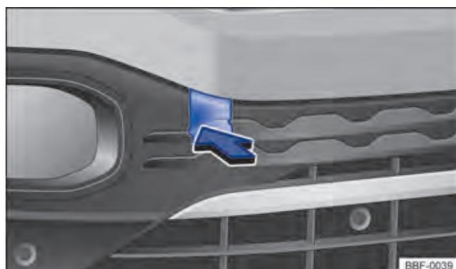
Figure. 152 Sur le pare-chocs avant droit : déclipsez et déposez le cache.
