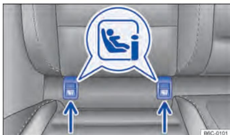
Figure. 42 Sur le siège du véhicule : repérage des ancrages inférieurs des sièges enfants.
