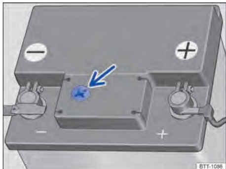
Fig. 163 Dans le compartiment moteur : exemple de position de l'afficheur en face supérieure de la batterie du véhicule.
