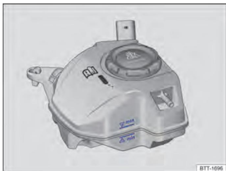
Figure. 160 Dans le compartiment moteur : repère sur le vase d'expansion du liquide de refroidissement moteur.
